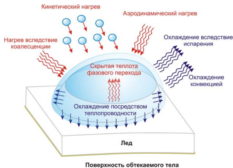
Рис. 7. Схема тепловых потоков при затвердевании капли воды на поверхности тела
